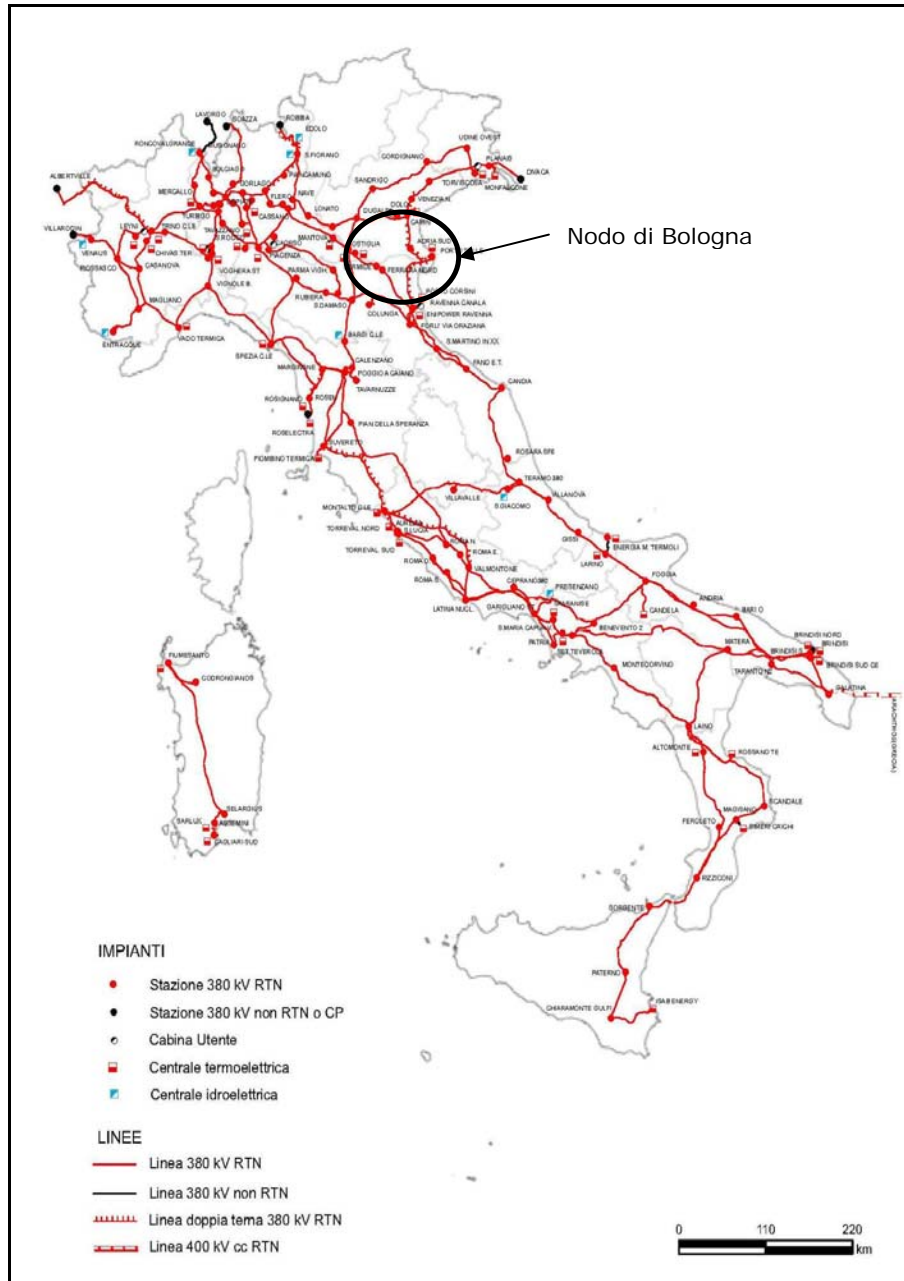
Figura 3.2: rete elettrica Italiana a 380 kV.
